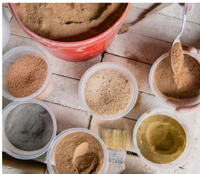
Zdjęcie 1. Minerały używane do produkcji tynków glinianych
