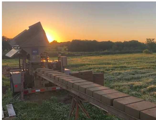
Zdjęcie 14. Produkcja bloczków prasowanych z mieszanki cementowo-glinianej
