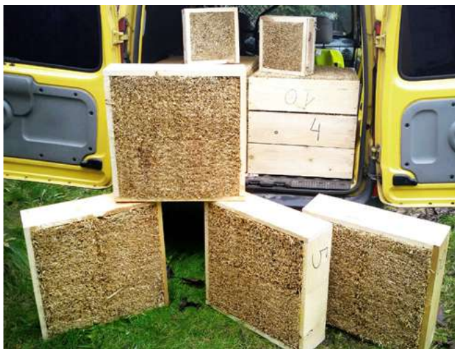
Zdjęcie 3. Próbkę przygotowane na zlecenie OSBN do badania współczynnika przewodności cieplnej kostek słomy. Wykonawca próbek: Moritz Reichert.
