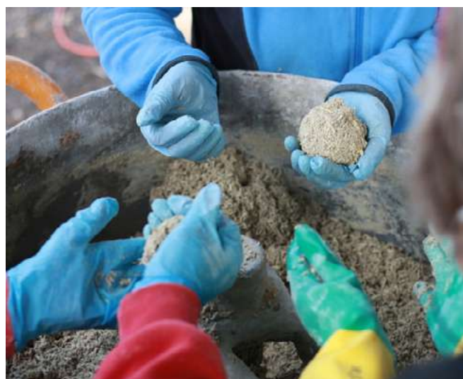
Zdjęcie 2. Sprawdzenie konsystencji metodą „kulki i palca”
