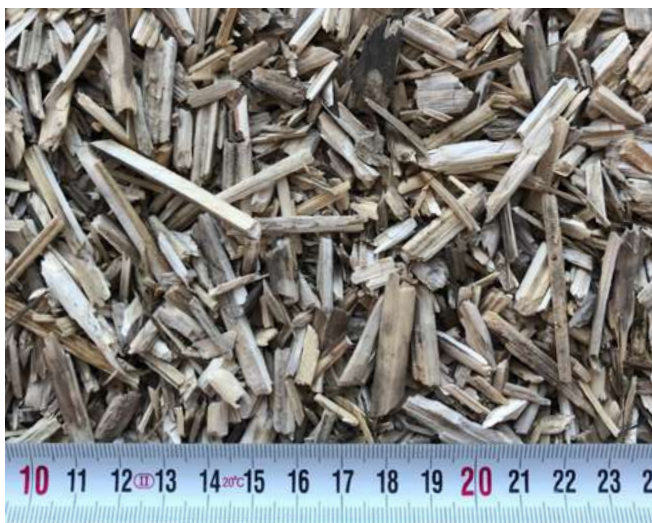
Zdjęcie 4. Paździerz wykorzystywany do betonu konopnego wyprodukowany przez polską firmę
