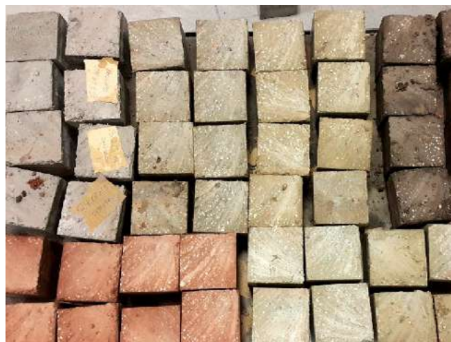
Rysunek 10. Próbkę ziemi ubijanej gruntów o różnym uziarnieniu [15]
