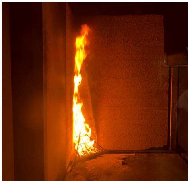
Zdjęcie 8. Reakcja na ogień ściany z konoplitu.
