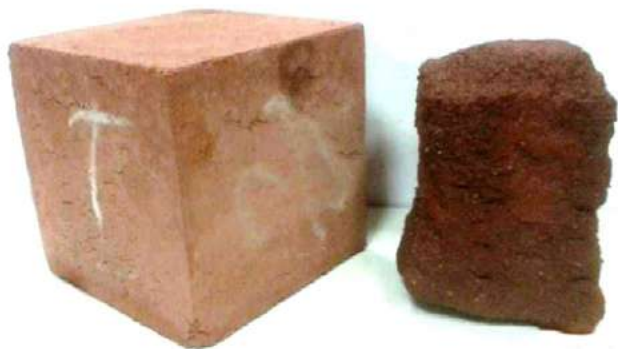
Rysunek 2. Efekt długotrwałego działania wody na próbkę ziemi ubijanej nie stabilizowanej dodatkowym spoiwem. Po lewej próbka przed zanurzeniem w wodzie; po prawej próbka po 30 minutowej ekspozycji w wodzie [4]
