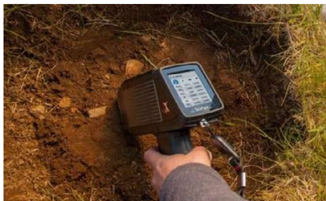
Zdjęcie 1. Badanie składu chemicznego gruntu przenośnym spektrometrem rentgenowskim
