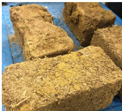
Rysunek 3. Materiał z gliny lekkiej użyty do recyklingu
