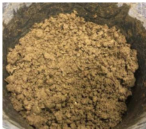
Rysunek 4. Konsystencja gliny lekkiej przed formowaniem próbek
