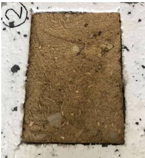
Rysunek 7. Próbkę z gliny lekkiej przygotowaną do badania na przewodność cieplną
