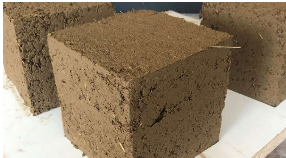
Rysunek 6. Wykonane próbki recyklingowe z gliny lekkiej
