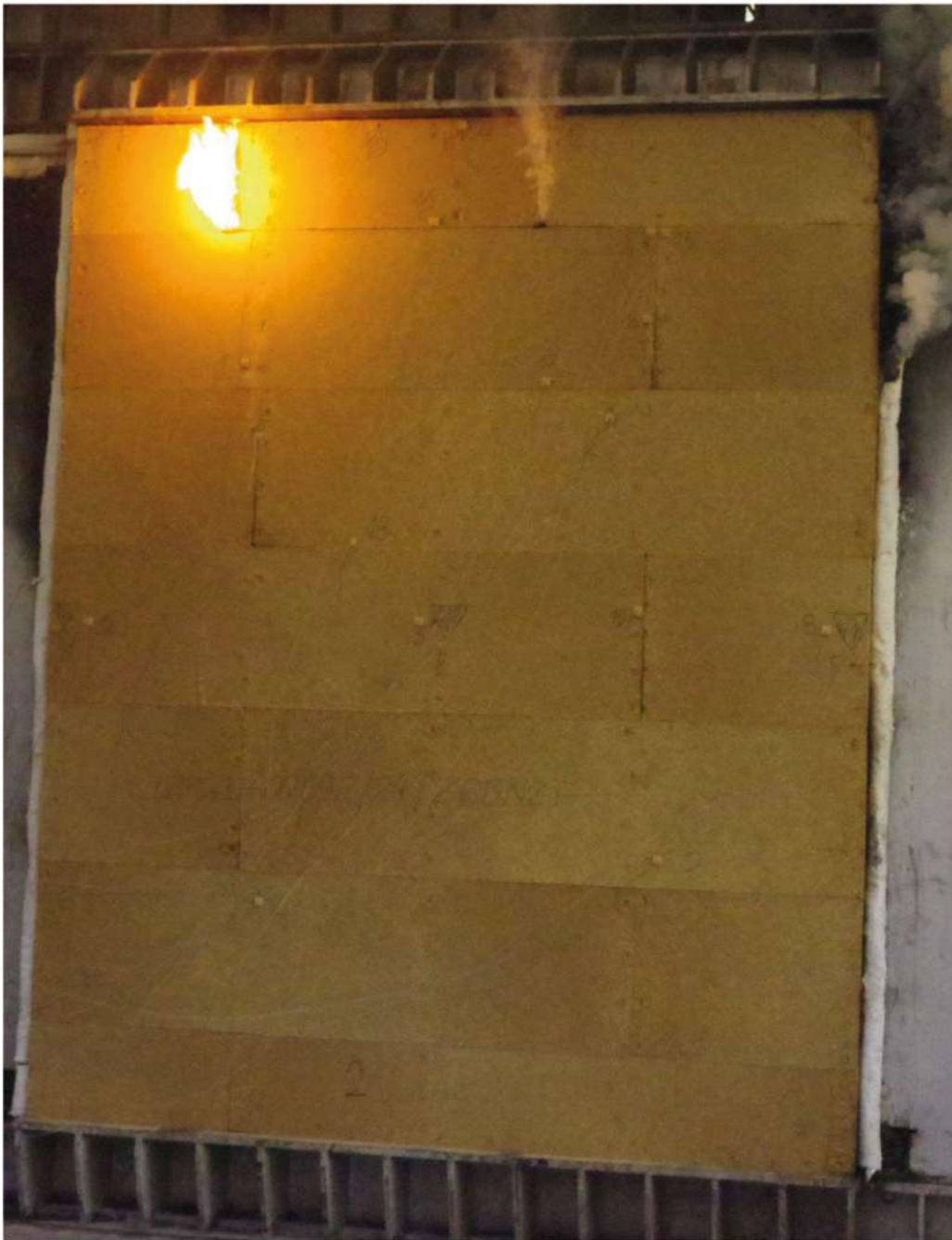
Rys. 20. Element próbny w trakcie badania, strona nienagrzewana, t = 132 \text{ min } 30 \text{ sek}
