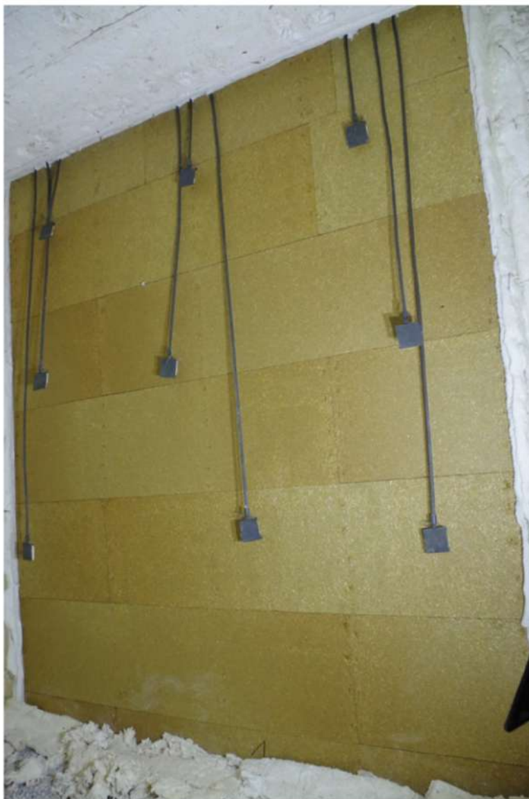
Rys. 2. Element próbny przed badaniem – strona nagrzewana
