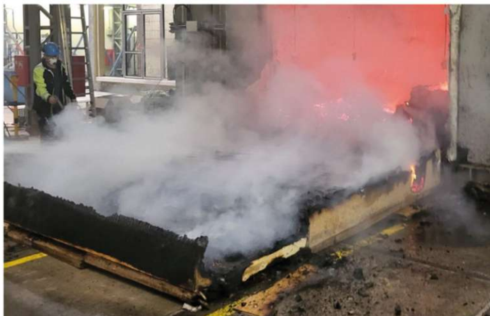
Rys. 22. Element próbny po badaniu, strona nagrzewana
