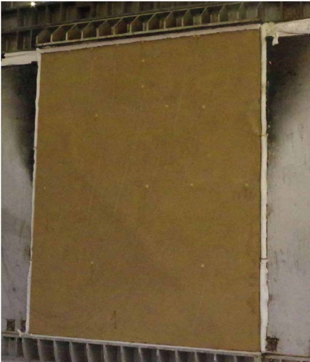
Rys. 16. Element próbny w trakcie badania, strona nienagrzewana, t = 60 \text{ min } 02 \text{ sek}
