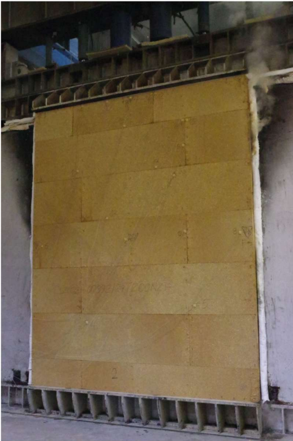
Rys. 16. Element próbny w trakcie badania, strona nienagrzewana, t = 60 \text{ min } 50 \text{ sek}
