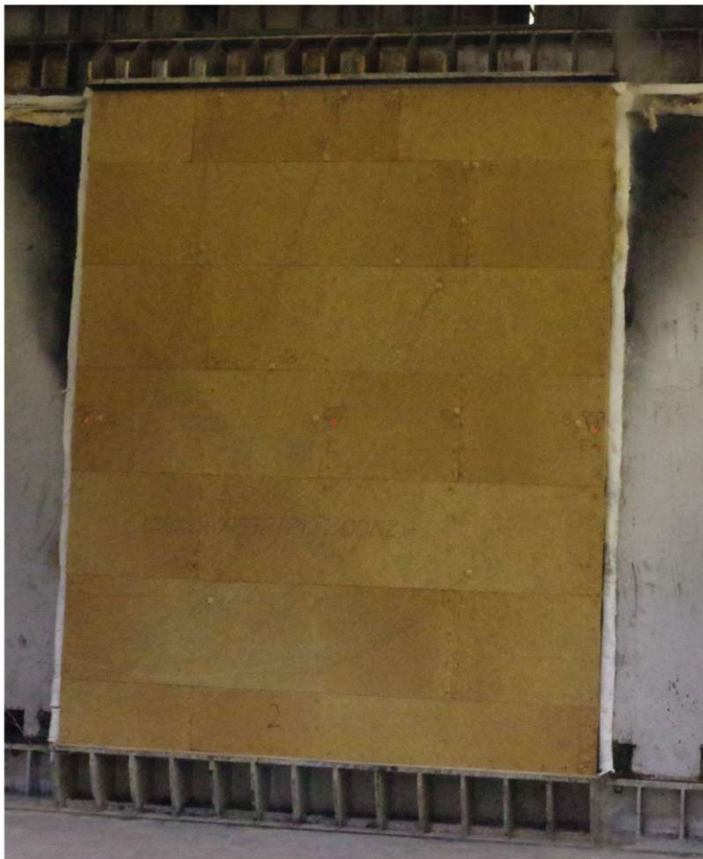
Rys. 15. Element próbny w trakcie badania, strona nienagrzewana, t = 32 \text{ min } 30 \text{ sek}
