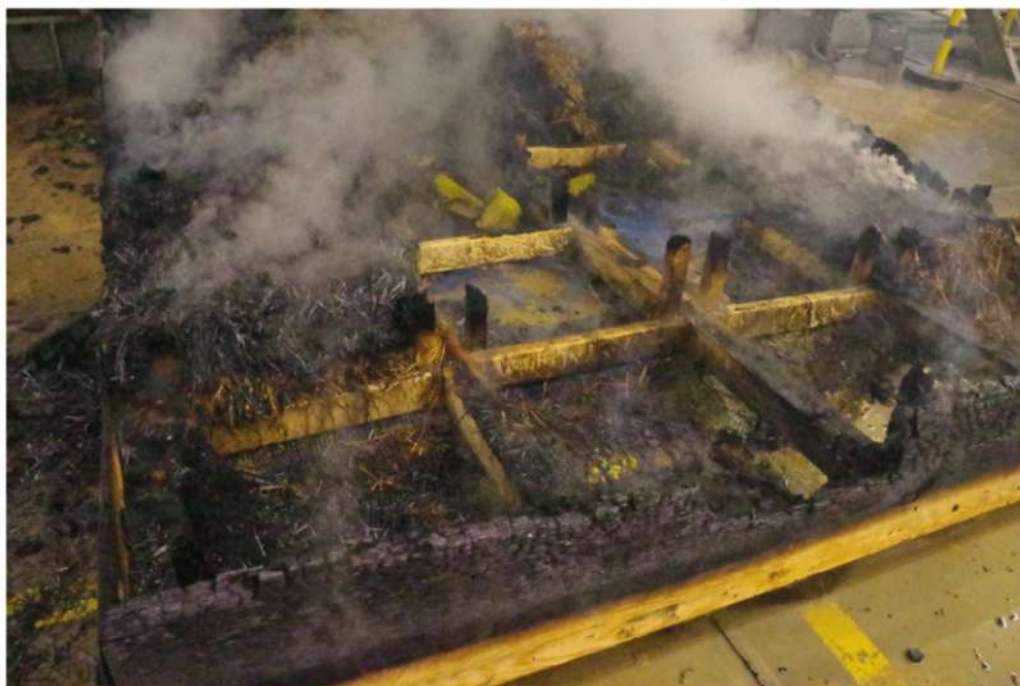
Rys. 21. Element próbny po badaniu, strona nagrzewana
