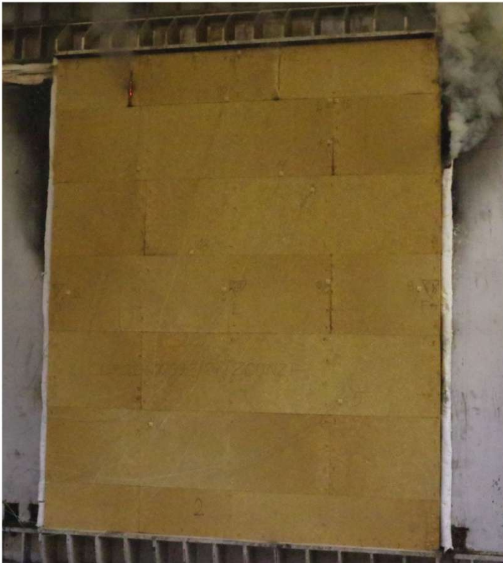
Rys. 19. Element próbny w trakcie badania, strona nienagrzewana, t = 129 \text{ min } 11 \text{ sek}
