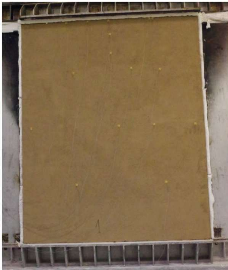
Rys. 1. Element próbny przed badaniem – strona nienagrzewana
