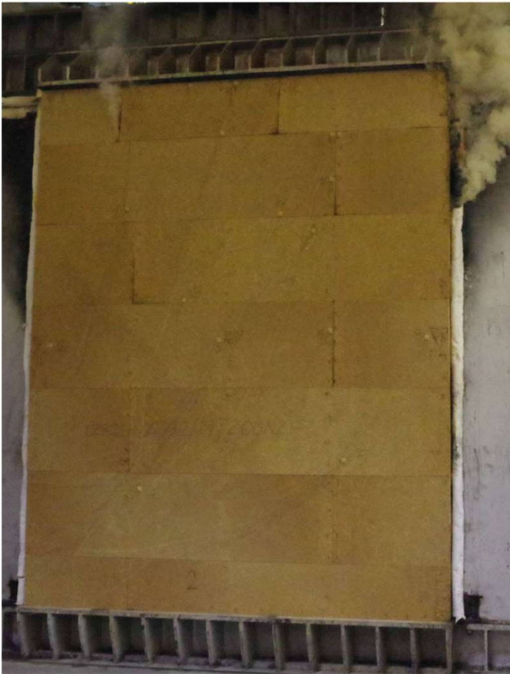
Rys. 18. Element próbny w trakcie badania, strona nienagrzewana, t = 120 \text{ min } 23 \text{ sek}
