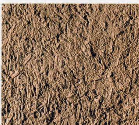
Strohlehmputz, Oberfläche „verklebt“
