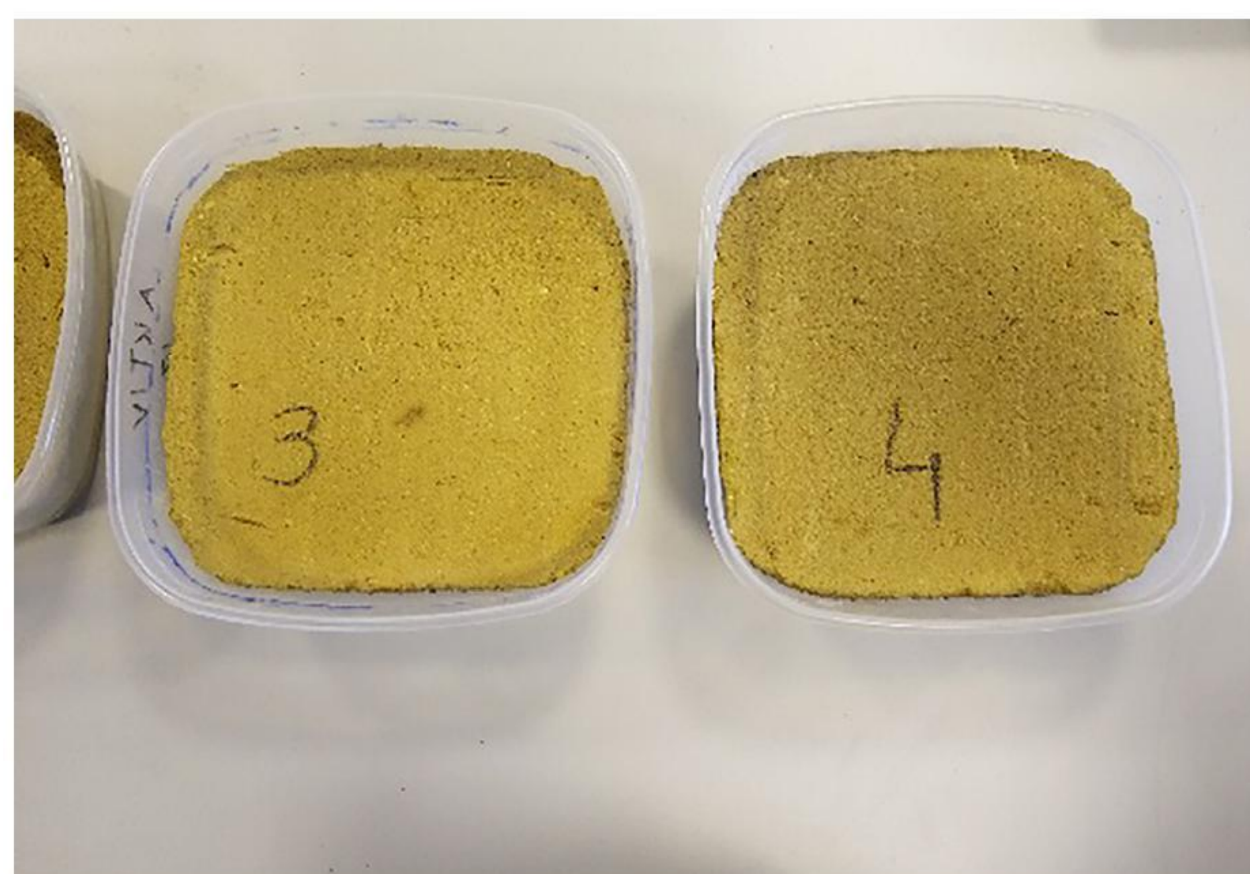
Rys. 3 Przygotowane próbki do pomiarów wilgotnościowych, po lewej stronie do badania sorpcji, po prawej do badania paroprzepuszczalności
