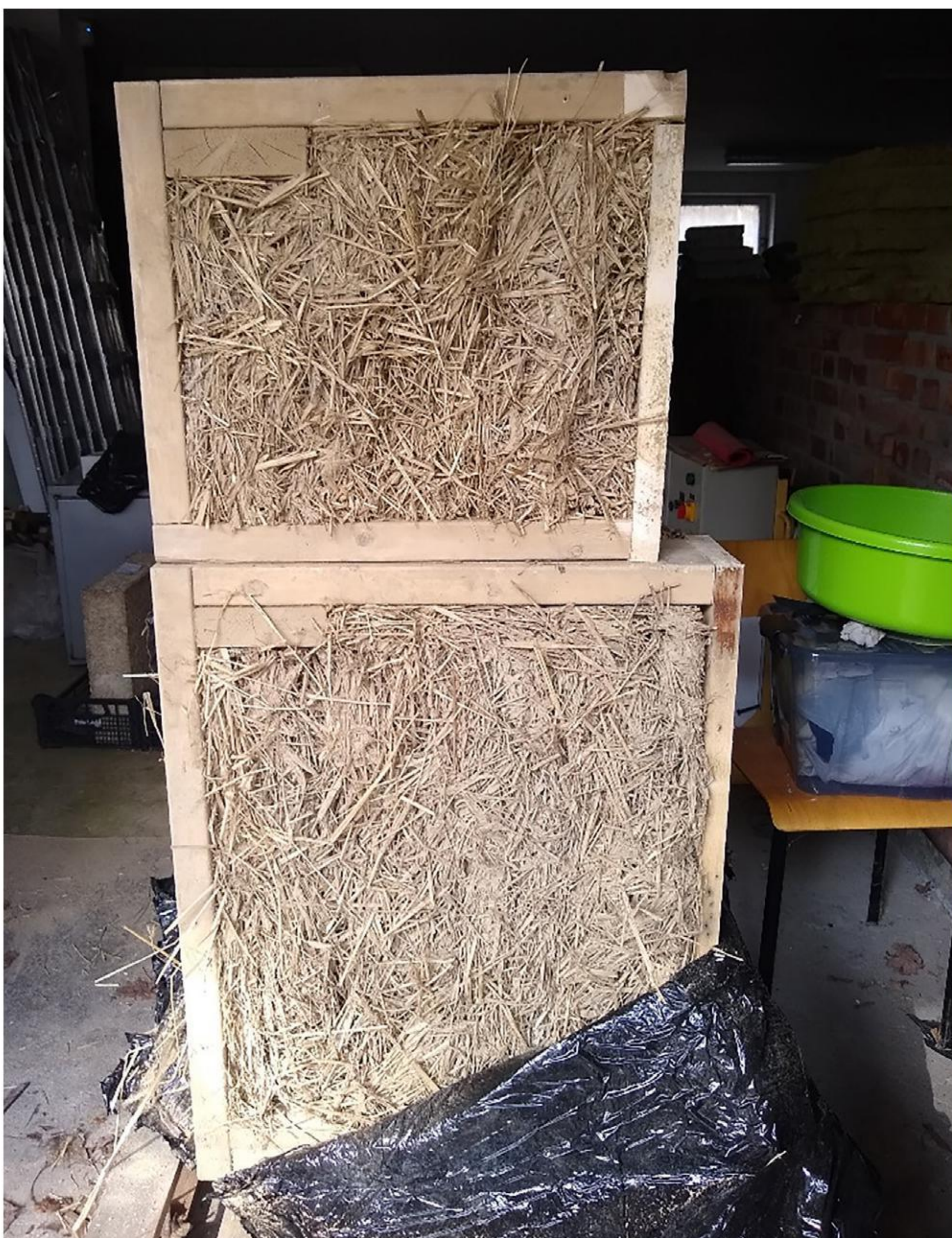
Rys. 1 Komponent słomiano-gliniany, oryginalne wymiary po lewej, zmniejszony na potrzeby badań po prawej
