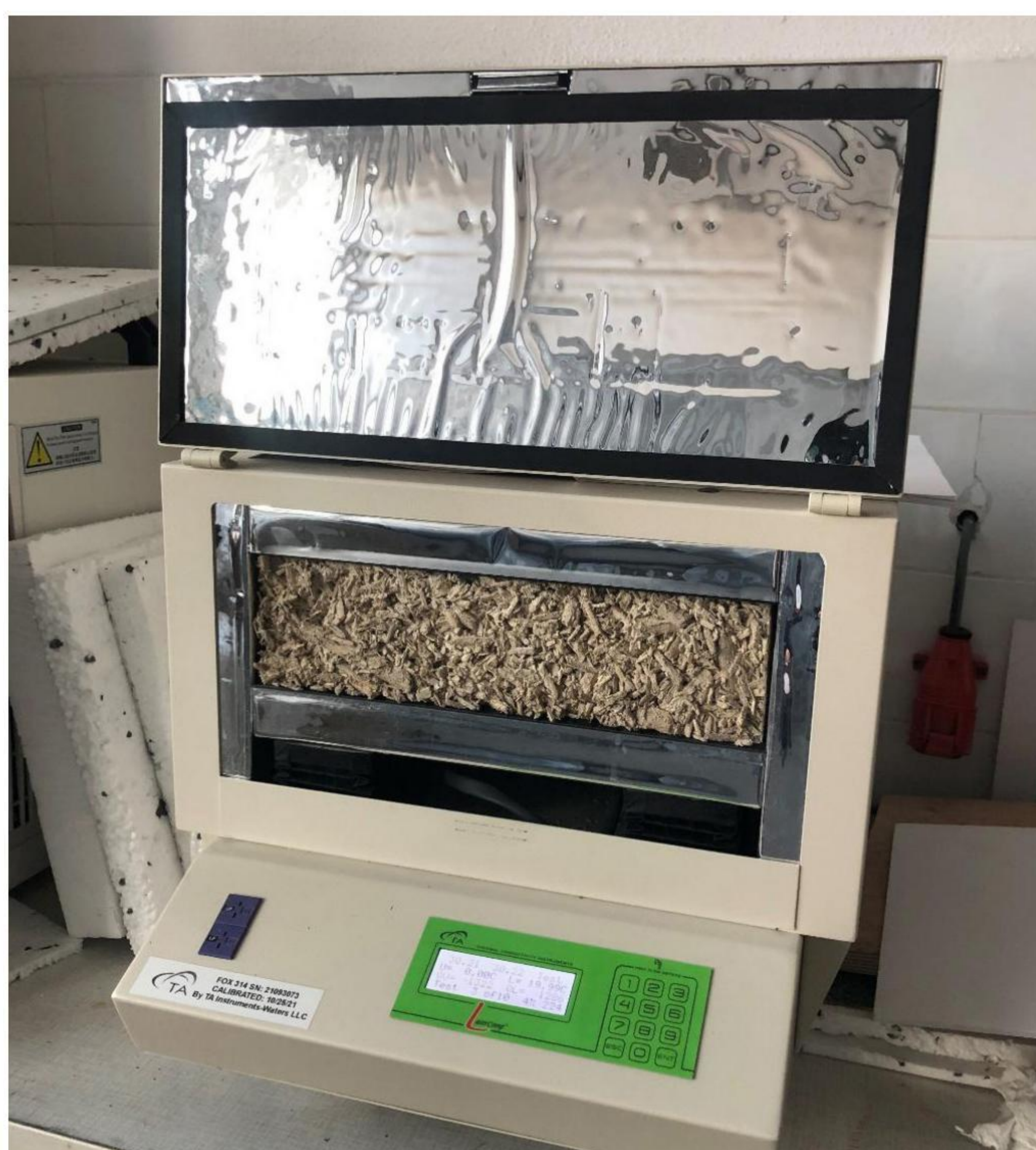
Rysunek 9. Badanie przewodności cieplnej w aparacie płytowym
