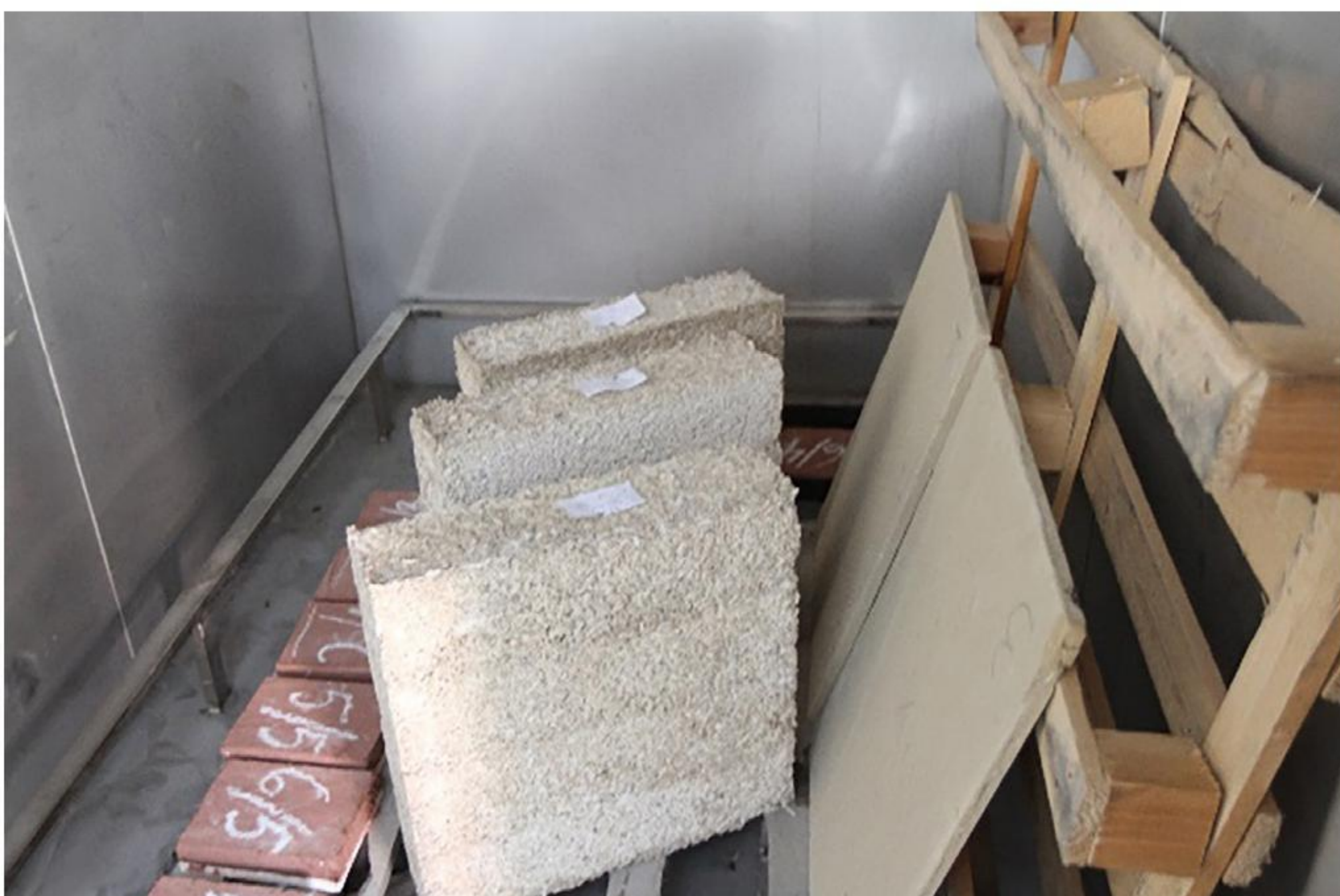
Rys. 2 Płyty gliniane w trakcie suszenia w temperaturze 80°C
