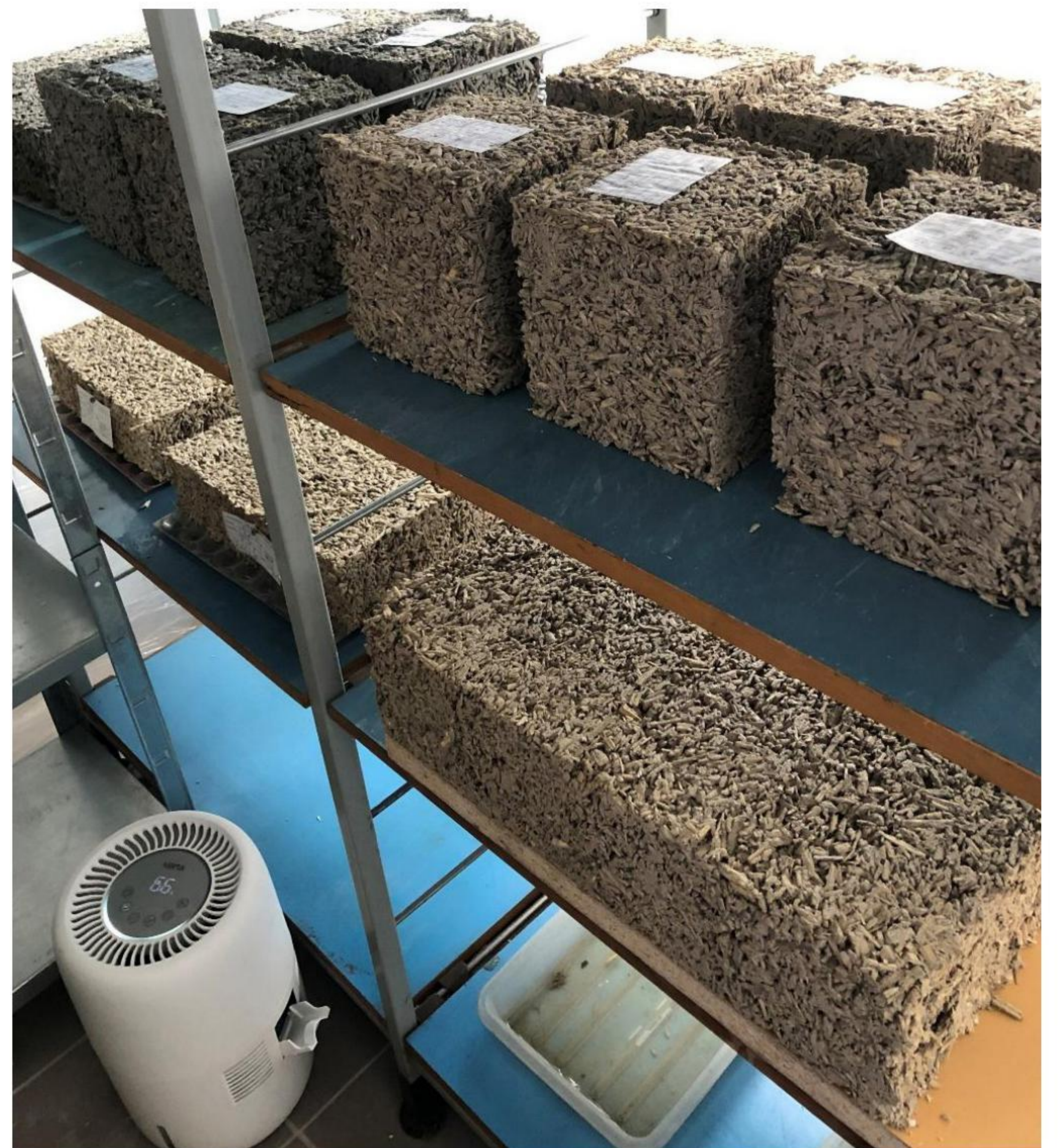
Rysunek 7. Sezonowanie próbek w komorze klimatycznej
