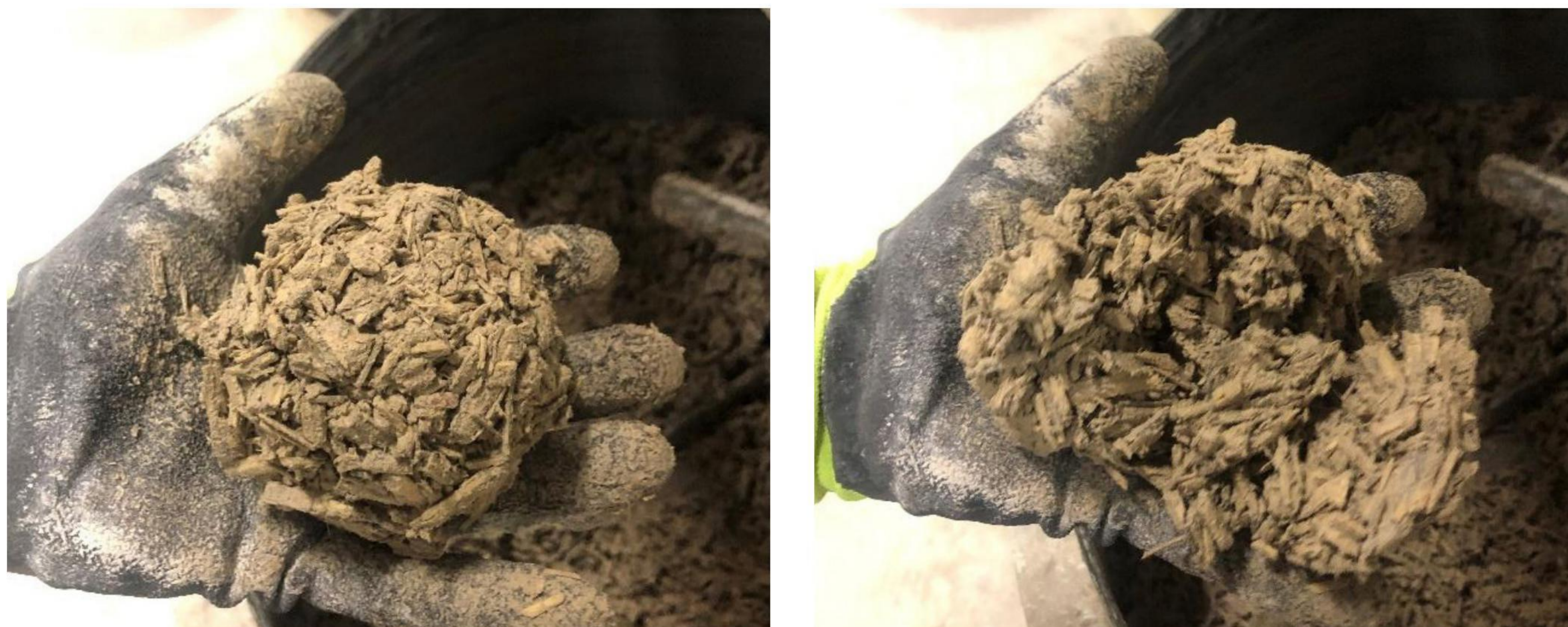
Rysunek 3. Sprawdzanie konsystencji metodą „kulki i palca”
