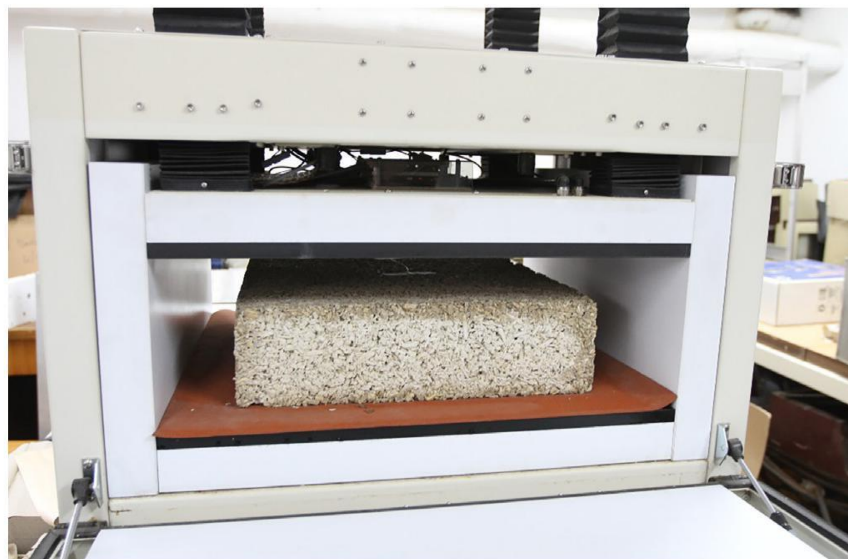
Rys. 5 Próbkę hempcrete umieszczona w komorze pomiarowej aparatu płytowego FOX 602
