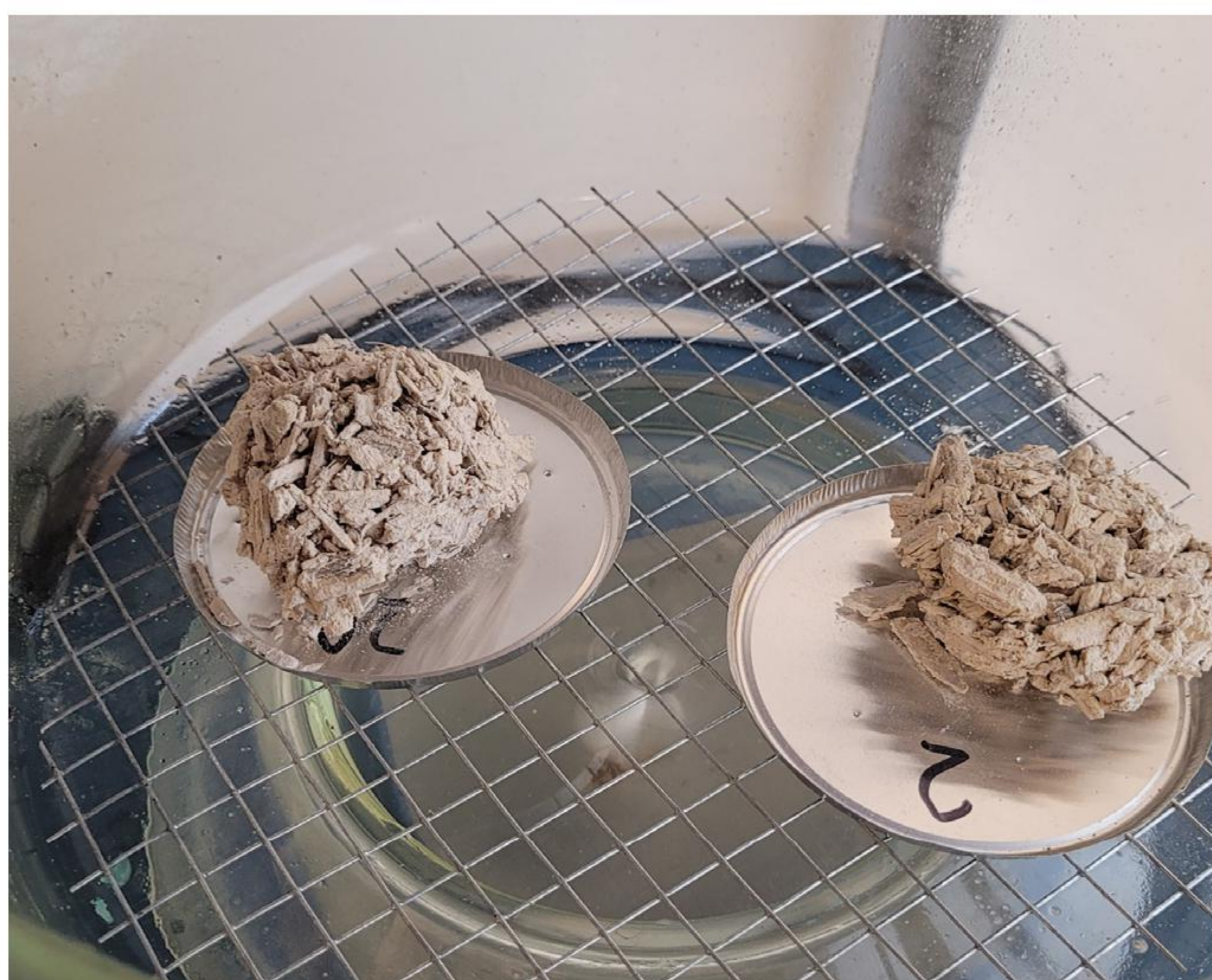
Rys. 7 Próbki hempcrete umieszczone na tackach w eksykatorze
