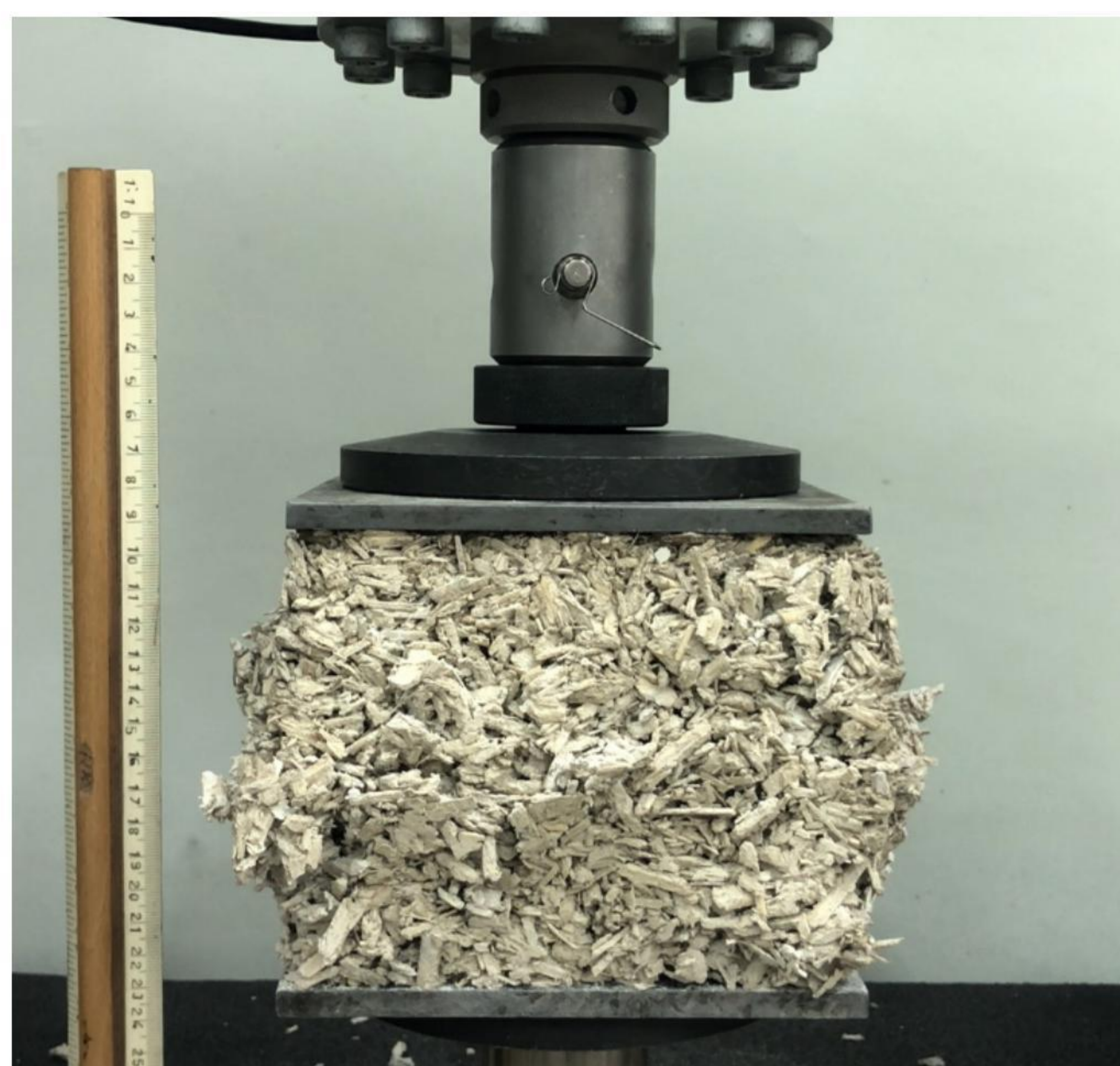
Rysunek 10. Badanie wytrzymałości na ściskanie. Widok próbki przy 20% odkształcenia
