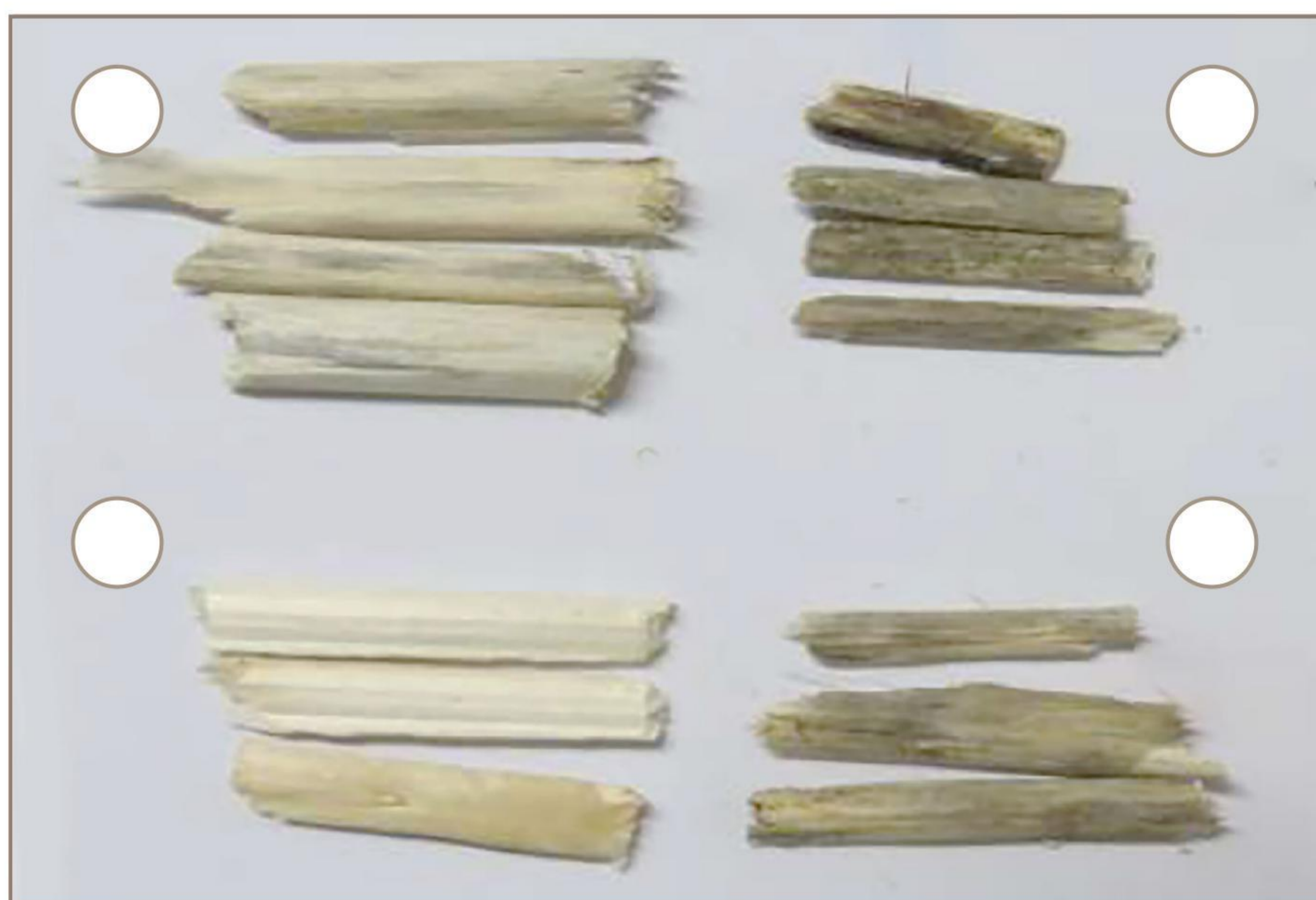
Rysunek 1. Wzornik dopuszczalnej barwy paździerzy do celów budowlanych stosowany przez Francuską Organizację Budownictwa Konopnego (cząstki 1 i 3 są akceptowalne, 2 i 4 nie)
