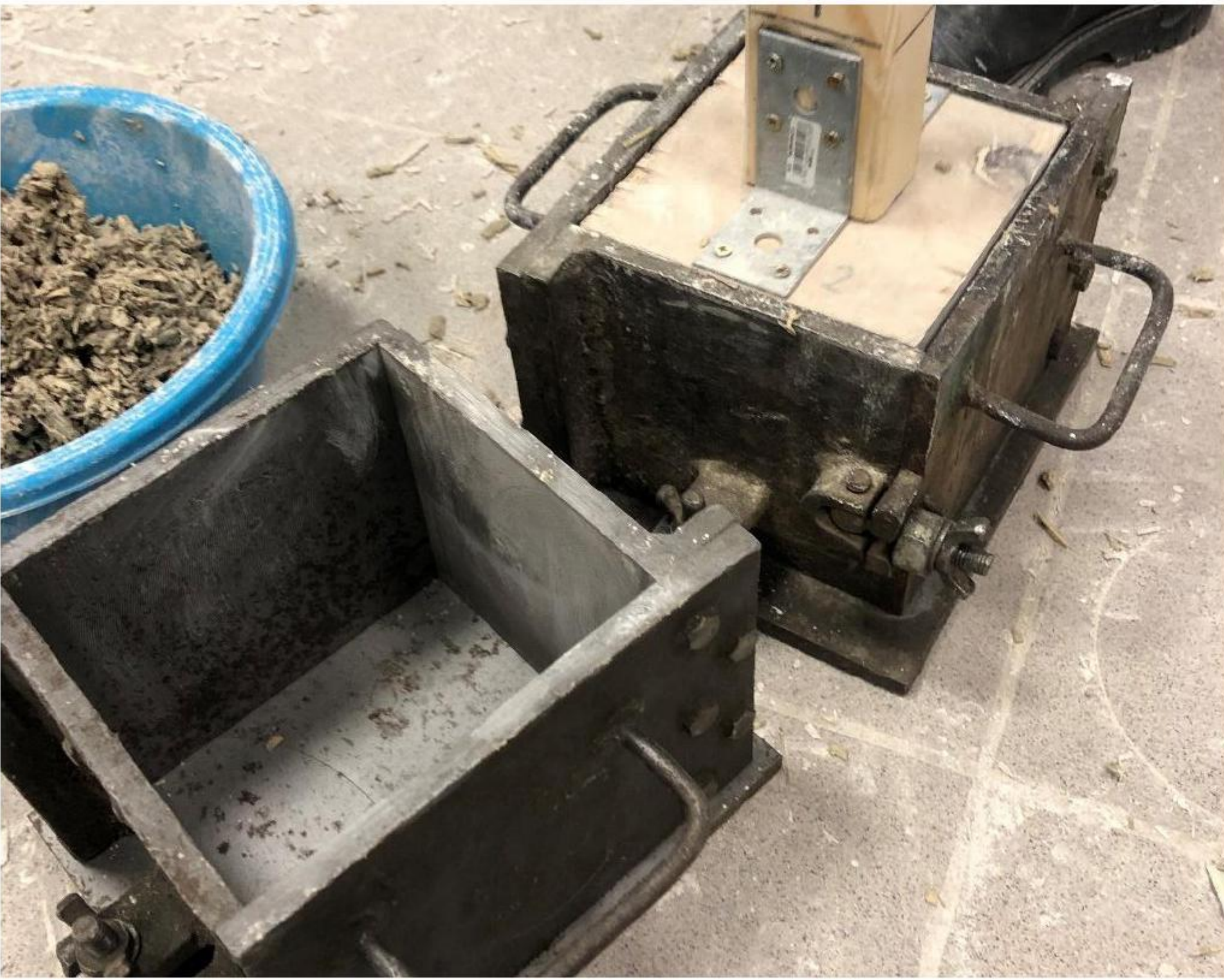
Rysunek 6. Formowanie próbek na wytrzymałość na ściskanie
