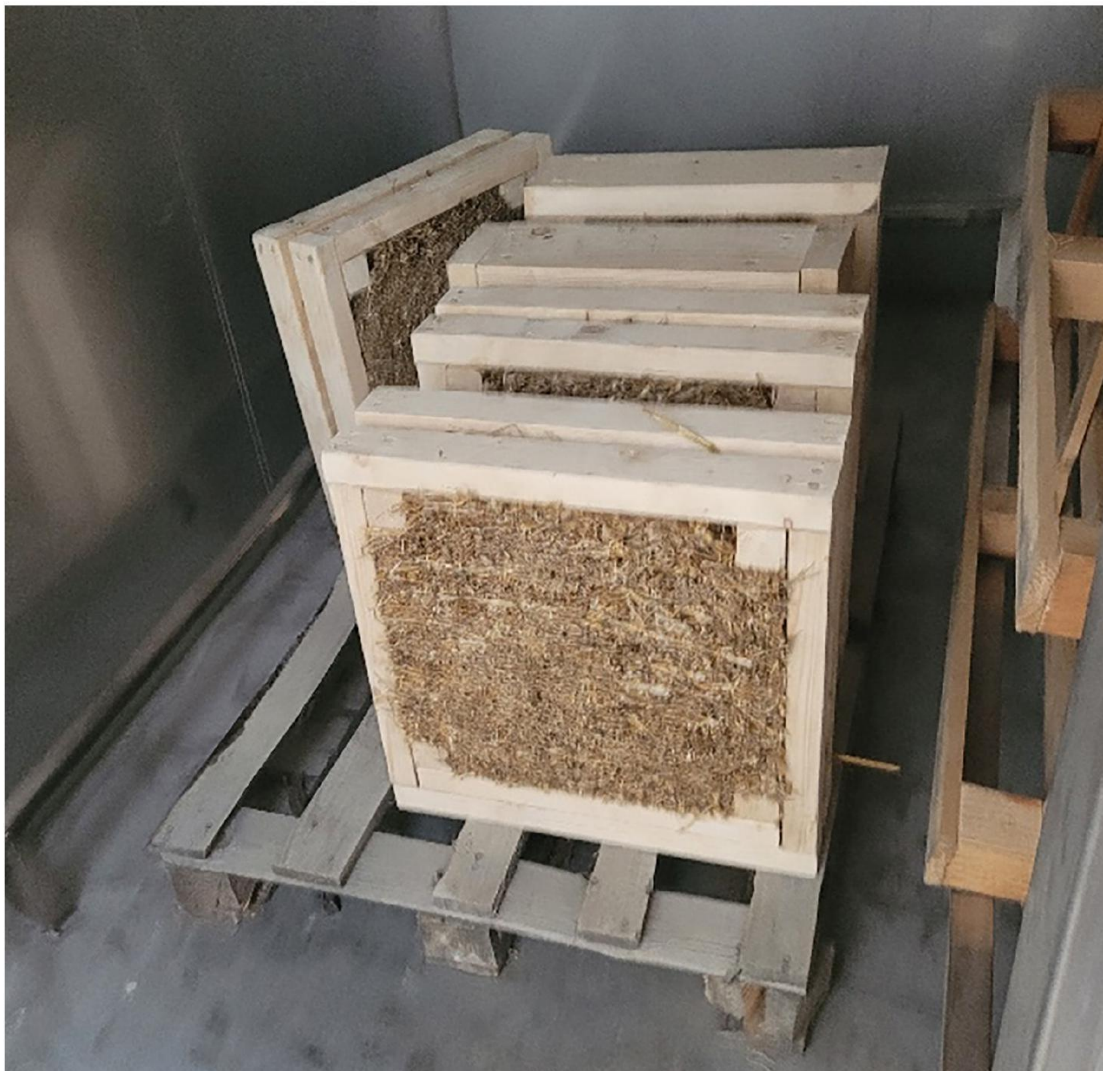
Rys. 2 Panele drewniane wypełnione słomą w trakcie suszenia w temperaturze 70°C
