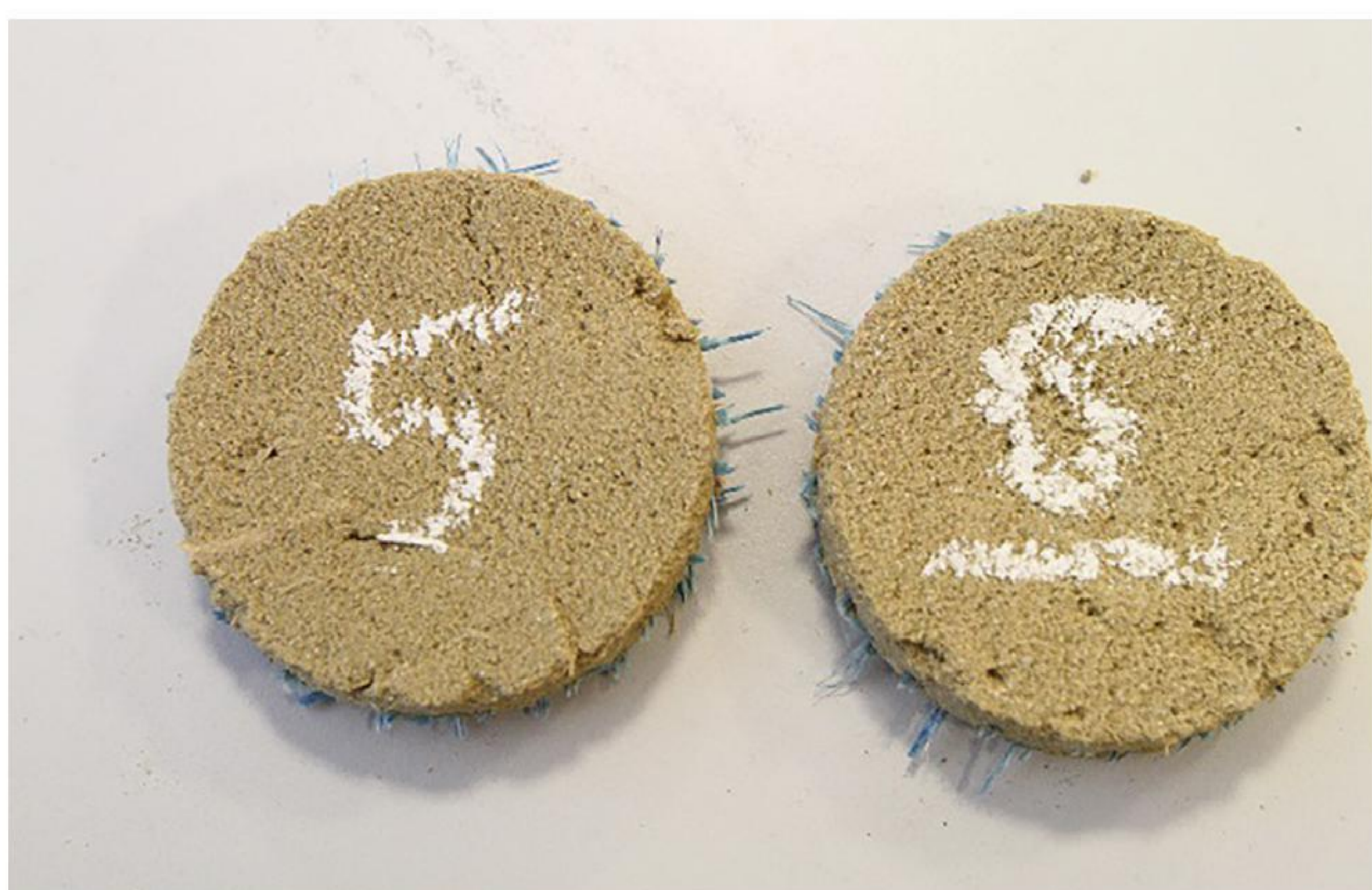
Rys. 3 Przygotowane próbki do pomiarów wilgotnościowych, po lewej stronie do badania sorpcji, po prawej do badania paroprzepuszczalności
