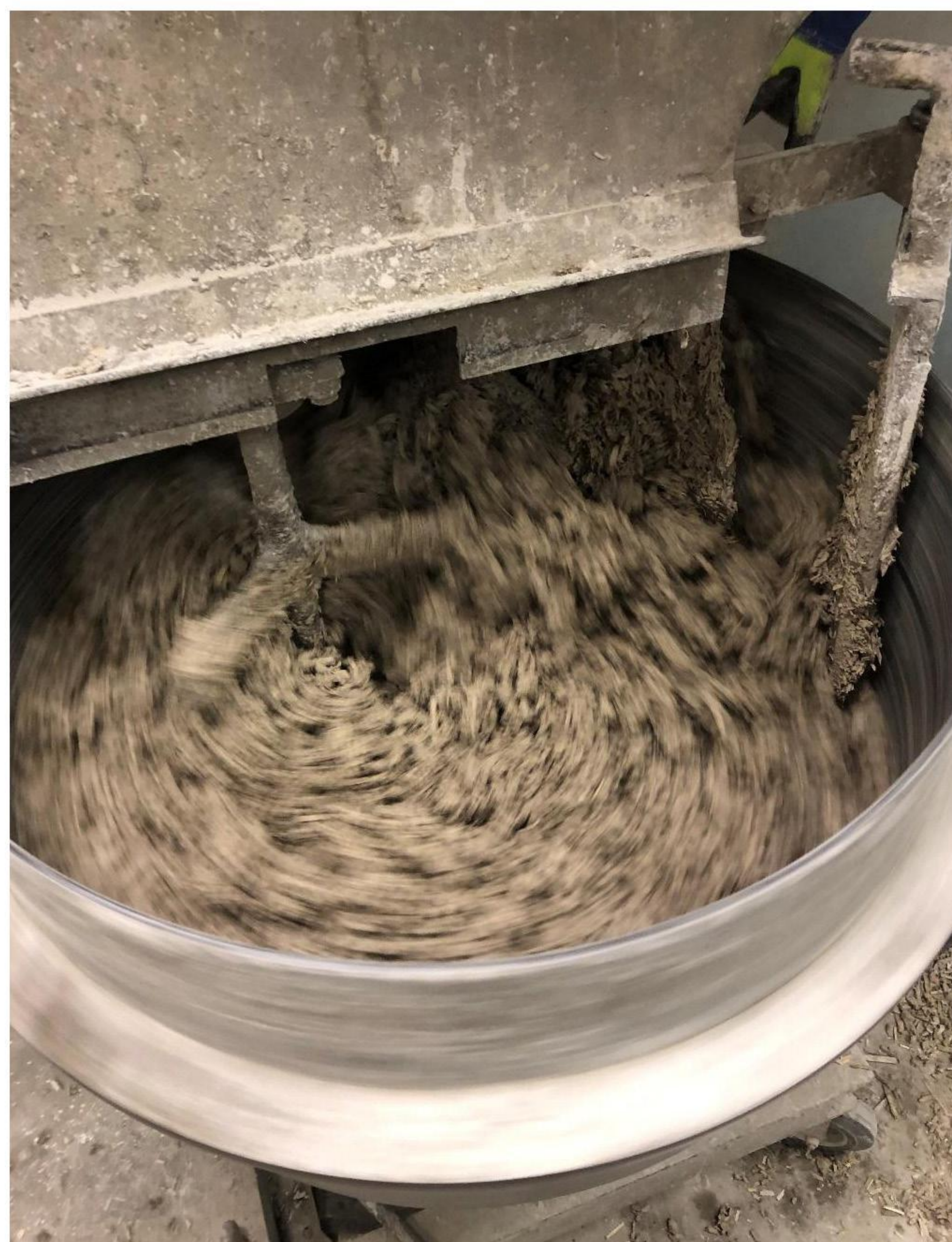
Rysunek 2. Mieszanie składników w mieszalniku z pionową osią obrotu
