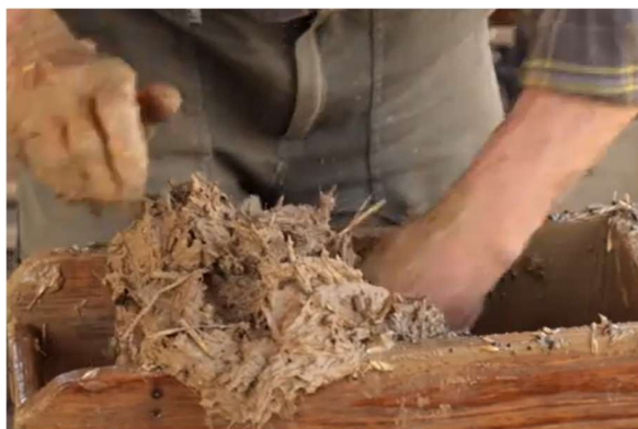
Formowanie cegieł (Źródło: E-Academy of Building Trades (E-Akademia Budownictwa), Környezettudatos Építők Szervezete)
